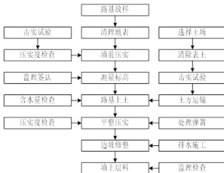
图 2.2-3 填方路基施工工艺流程图
